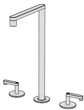
Set per lavabo tre fori composto da due comandi piantana con vitone ceramico e bocca di erogazione girevole (160°) rialzata senza salterello e scarico
