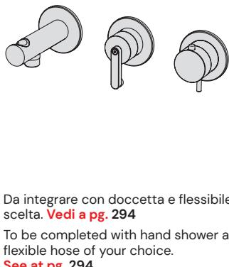
Parte estetica per miscelatore doccia incasso termostatico con deviatore 2 vie integrato e presa acqua con supporto, per installazione orizzontale
