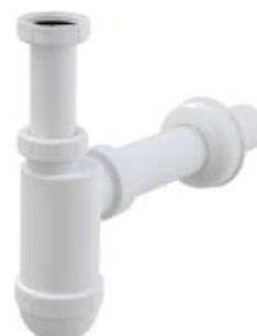
A40 Sifon umyvadlový „T“ Ø 40 mm s převlečnou maticí 5/4", délka max. 250 mm, plast BDK2T2D 82 Kč • 3,26 €
