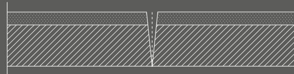
**LA RECTIFICATION DES CARREAUX PRÉVOIT UNE COUPE AVEC UN LÉGER BIAIS POUR FACILITER LA POSE À JOINTS RÉDUITS :**
