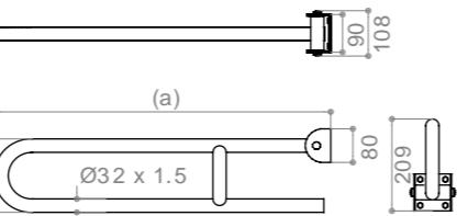
**RIBALTABILE CON PORTA ROTOLLO CON FRIZIONE PER BLOCCAGGIO VERTICALE**
