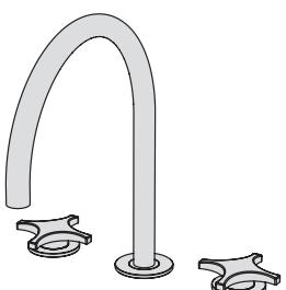
Set per lavabo tre fori composto da due comandi piantana con vitone ceramico e bocca di erogazione girevole (160°) media senza salterello e scarico
