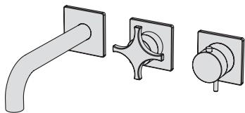
Parte estetica per miscelatore vasca incasso termostatico con deviatore 2 vie integrato e bocca di erogazione fissa L=190 mm, per installazione orizzontale
